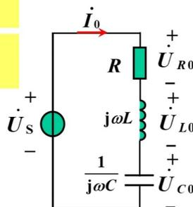
定义3: 在反映电流有效值与频率的关系, 称为电流的**幅频特性**; 反映电流相位与频率的关系称为电流的**相频特性**。
