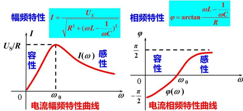
当  $\omega = \omega_0$ , 电流最大, 电压与电流同相位, 电路处于**谐振状态**;
