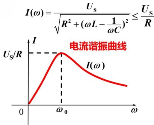
从电流谐振曲线可以看出, 在谐振频率附近, 电路具有较大电流, 而外施信号频率偏离谐振频率越远, 电流越小, 这表现出了串联谐振电路具有选择最接近谐振频率信号, 同时抑制其他信号的能力, 称为**电路的选择性**。
