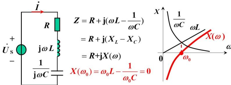
**谐振的定义：**对于任何含有电感和电容的一端口电路，在一定条件下可呈现电阻性，其端口电压与电流同相位，则称此一端口电路发生**谐振**。
