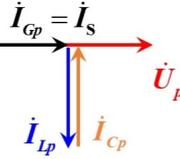
谐振时电容支路和电感支路的电流有效值相同，都等于总电流的Q倍，但是方向相反。
