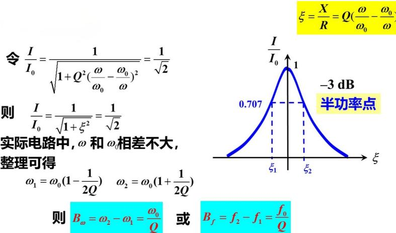
如果信号占有的频带在谐振曲线最大值  $1/\sqrt{2}$  倍的两点之间, 这两点之间的频率范围称为谐振电路的**通频带**。通频带的边界两点, 对应于信号最大功率的一半, 也称为**半功率点**。
